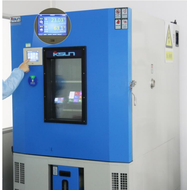
图 5-4 高低温老化测试图
